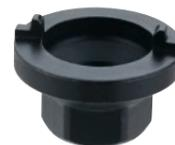
Outil démonte roue libre 4 encoche pour BMX. Acier Cr-Mo. Utilisable avec clef plate 24 mm.
