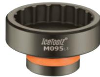
12-Outil de montage pour boîtier à dents Pour Hawk Racing™ BB3086™, RaceFace® Cinch™, Rotor® BSA30, Zipp® Vuma™ et autres système de boîtier externes. Acier Cr-mo renforcé s'utilise avec carré 1/2" (#53D4).
