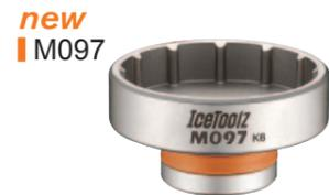
Outil démonte roue-libre compatible Shimano® MF, Campagnolo® et systèmes BB mount 12 dents. Utilisable avec notre poignée 1/2" #53D4 ou avec une clef plate 21mm.
